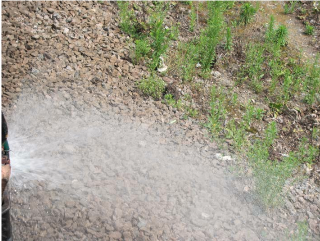
Визуализация рассеивания капель рабочей жидкости боковыми форсунками центральной штанги путевого гидравлического опрыскивателя ОПШ-5А при скорости опрыскивания 30 км/ч
